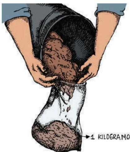
9. Colocar cada muestra en doble funda, entre las dos fundas poner una tarjeta de identificación para su envío al laboratorio.
